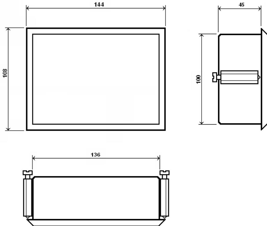
**«Габаритные и присоединительные размеры датчика электропроводности и температуры ДЭТ9-10Т»**
