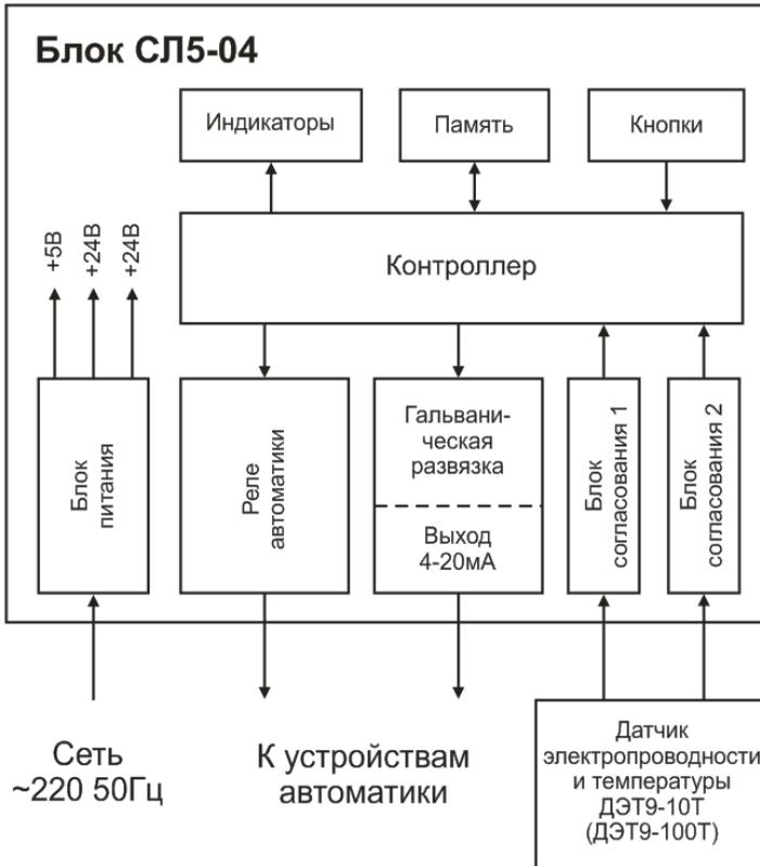
«Схема внешних соединений Блока СЛ5-04»
